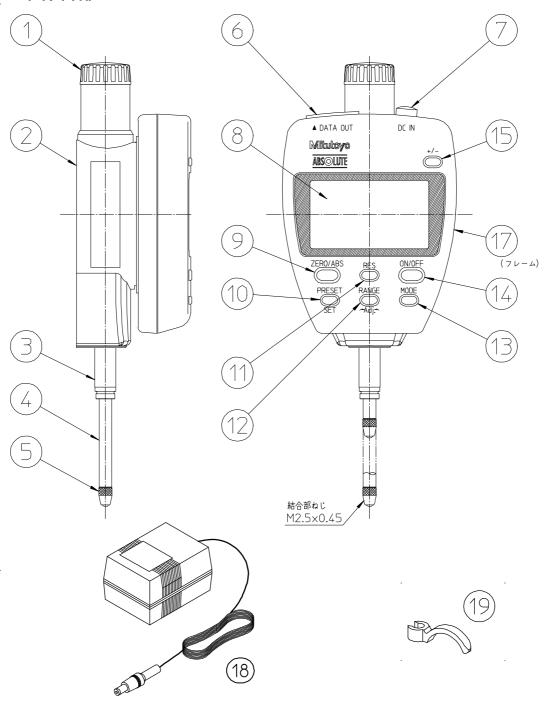
キャップ ウラブタ ステム スピンドル 測定子 出力コネクタ DC ジャック LCD
