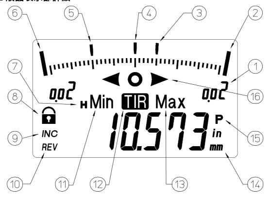
アナログレンジ表示 上オーバーレンジ 上針(点滅) 指針 下針(点滅) 下オーバーレンジ データホールド表示 ファンクションロック表示 比較測定系(INC)時表示 逆カウント測定時表示 最小値ホールドモード表示 TIR(振れ)測定モード表示 最大値ホールドモード表示 単位表示 プリセット値設定中表示 合否判定表示
